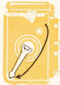
Die Filmeinstellung zur 1. Aufnahme erfolgt durch volle Kurbelumdrehungen (etwa 4 bis 5 x) bis zum Anschlag. Kurz davor ist der Widerstand des Tastwerks zu überwinden.
