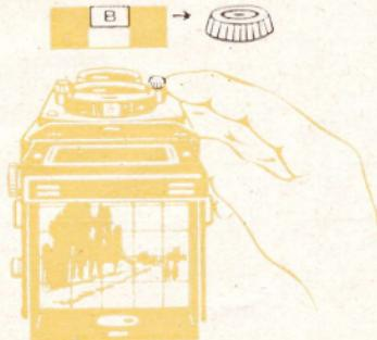
Avec temps de pose B l'obturateur reste ouvert aussi longtemps que le déclencheur est enclenché.
