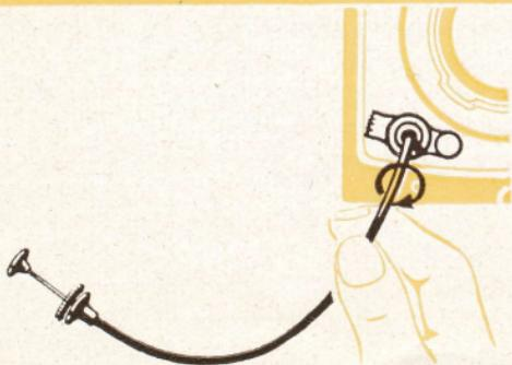
Déclencheur à fil souple
