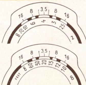
Les doubles chiffres des diaphragmes sur le bouton de mise au point indiquent où commence et où s'arrête la profondeur de champ pour chaque mise au point désirée et pour chaque diaphragme. Ex.: Mise au point sur 4 m. avec diaphragme 8 donne de 3 à 6 m. de profondeur de champ, avec diaphragme 16 de 2,5 à 10 m.
